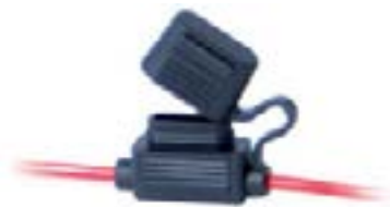
14.115.19 Высококачественный держатель из термопластика для стандартных флажковых предохранителей. В комплекте два провода длиной 130 мм и сечением 4 мм 2 . Максимальный ток 30 А.
