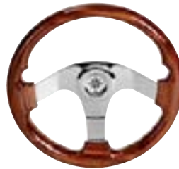
45.160.00 Со спидами и ступицей из нержавеющей стали зеркальной полировки. Ступица с универсальным посадочным конусом, с регулировкой центровки рулевого колеса. Наружный Ø 350 мм.
