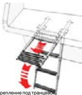
▲ Крепление под транцевой площадкой
