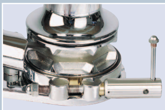
Ленточный тормоз VWC3500 с оригинальным рычагом управления Maxwell
