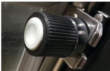
Система крепления для складывающегося (на петлях) ветрового стекла.
