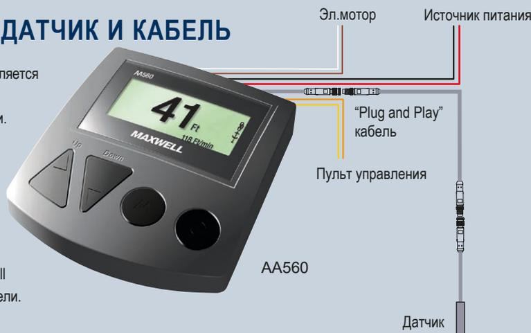
**ВСЕ ЛЕБЕДКИ MAXWEL ПОД ГОТОВЛЕННЫ К ИСПОЛЬЗОВАНИЮ СЧЕТЧИКА ЦЕПИ: НА НИХ УСТАНОВЛЕННЫ МАГНИТЫ И ПРОСВЕРЛЕННЫ ОТВЕРСТИЯ ДЛЯ ДАТЧИКА.**
