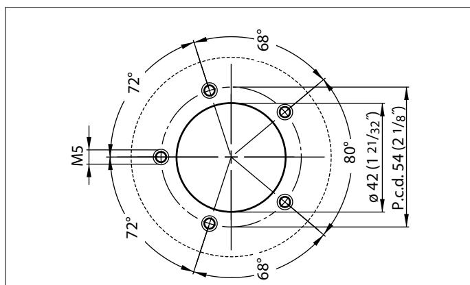
**Aansluiting voor tankniveausensor:**
